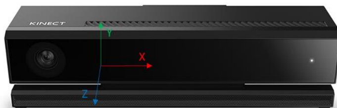
Figura 12.– Posición y direcciones de crecimiento de las variables X Y Z asociadas al origen de coordenadas de un CameraSpacePoint
